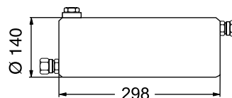
Охладитель импульса давления V2
