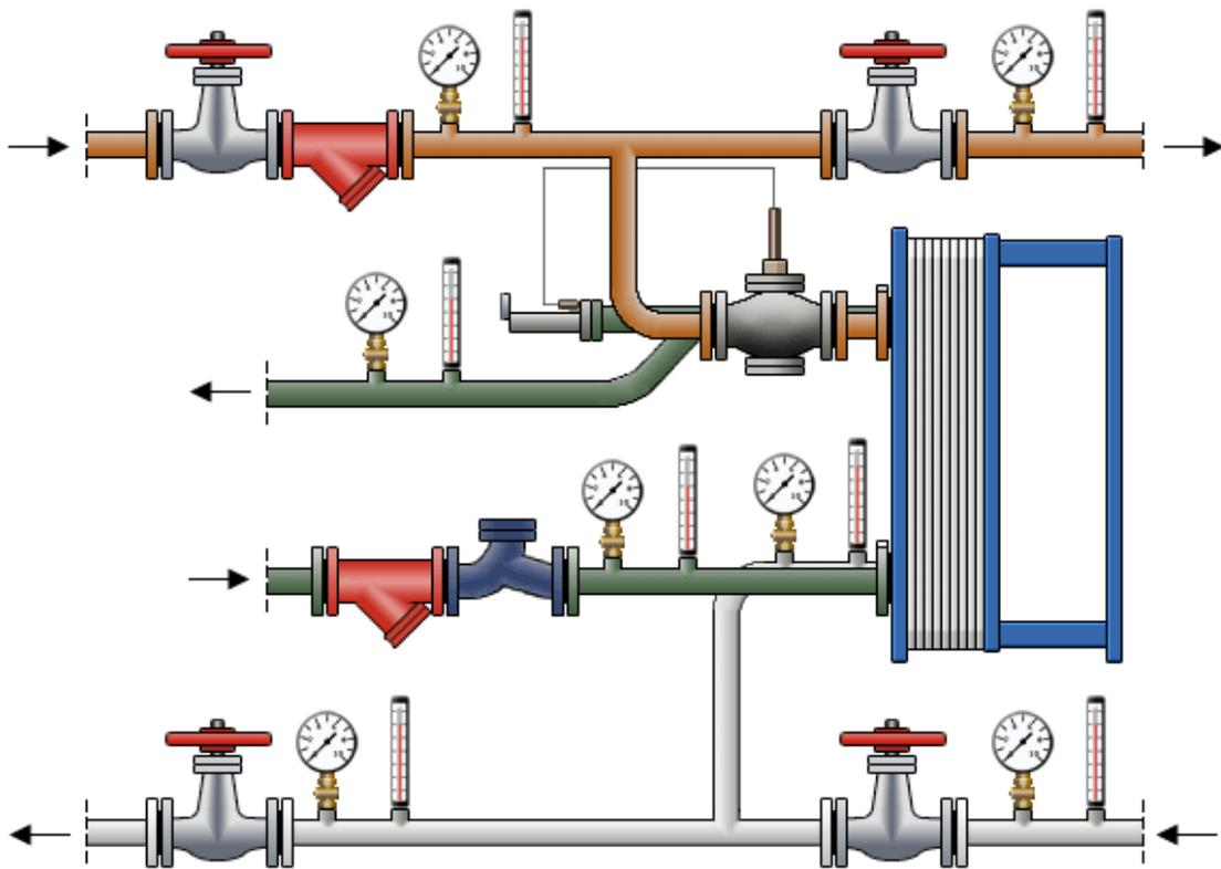
**Установка регулятора температуры РТ-ДО на обратном трубопроводе системы отопления**
